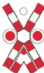
Trecere la nivel cu o cale ferată dublă, fără bariere, prevăzută cu semnale luminoase de avertizare a apropiării trenului
